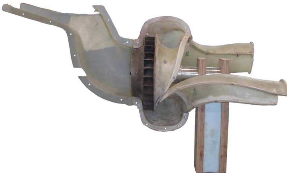
Abb. 8 Schubgebläse mit Schräglippenspirale – 2007 – halb geöffnet
